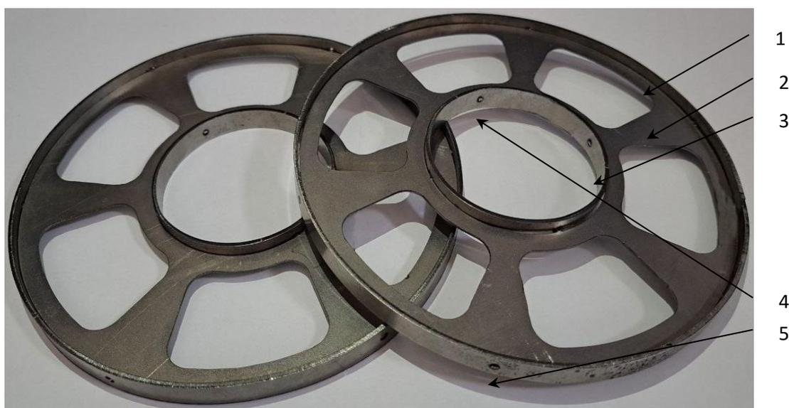
**Рисунок 3.** Новая конструкция междупильной прокладки линтерной машины.
