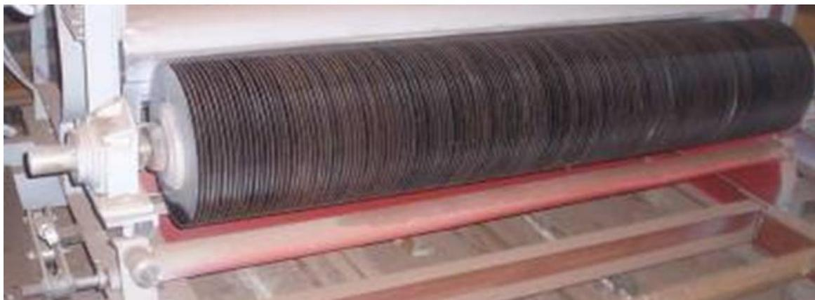
**Рисунок 2.** Пильный цилиндр линтерной машины 5ЛП.
