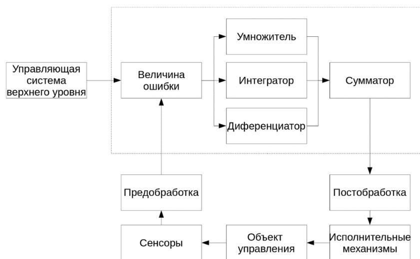
Рисунок 4. Функционально-логическая модель использования ПИД-регулятора.
