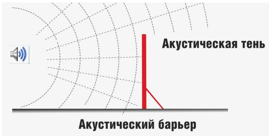
Рисунок 2. Работа защитного экрана.
